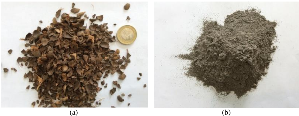
Figura 6. Cuesco de palma africana (a) y ceniza del cuesco de palma africana (b).
